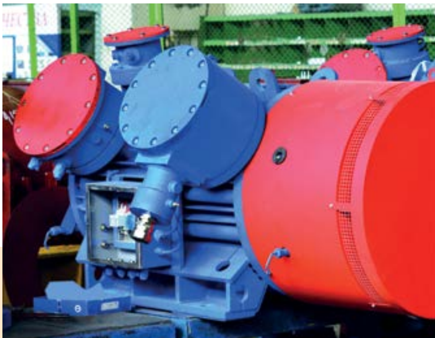
Фото 2. Взрывозащищенный электродвигатель с повышенным КПД и сниженным уровнем шума
