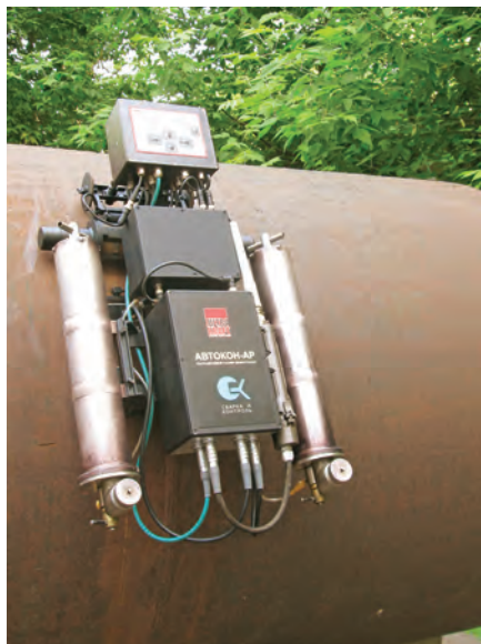
Рис. 4. Комплекс для автоматизированного ультразвукового контроля стыковых сварных соединений КСО
