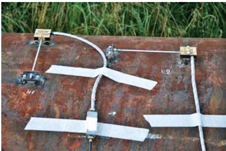
Рис. 2. Первичные преобразователи ВОД на испытываемой плети
