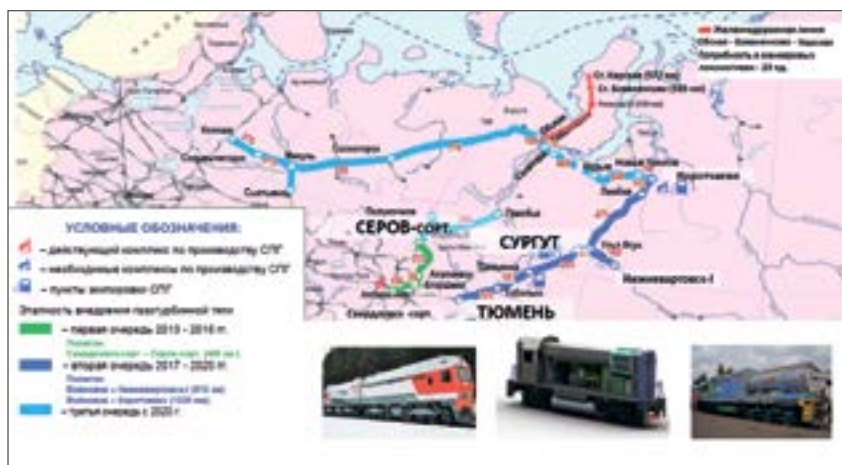
Рис. 6. Пример развития использования СПГ в качестве моторного топлива на железнодорожном транспорте (участок ж/д Войновка – Сургут – Лимбей, Обская – Карская)
