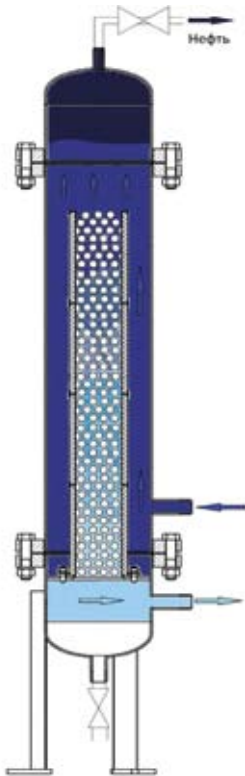
Рис. 2. Схема №1. Фильтр с эластичной загрузкой
