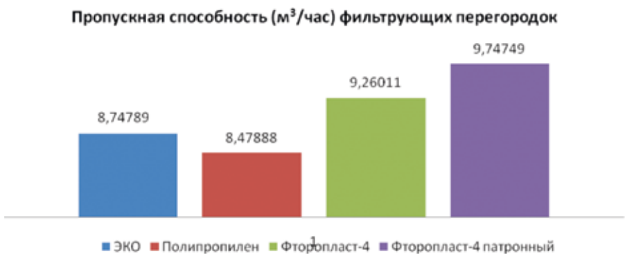
Рис. 10. Диаграмма пропускной способности фильтрующих перегородок
