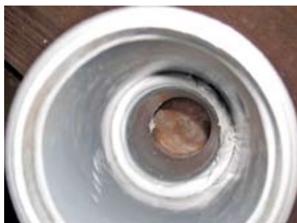
Рис. 4. Соединение труб с втулкой внутренней защиты сварного шва с применением герметика Г-039
