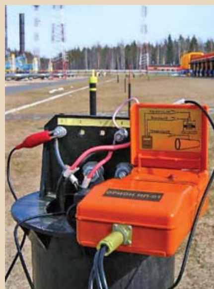
Рис. 2. КИП различных типов из полиэтиленовой трубы, оборудованные плакатом с идентификационной надписью в системе ПКЗ МГ Ямал – Европа
