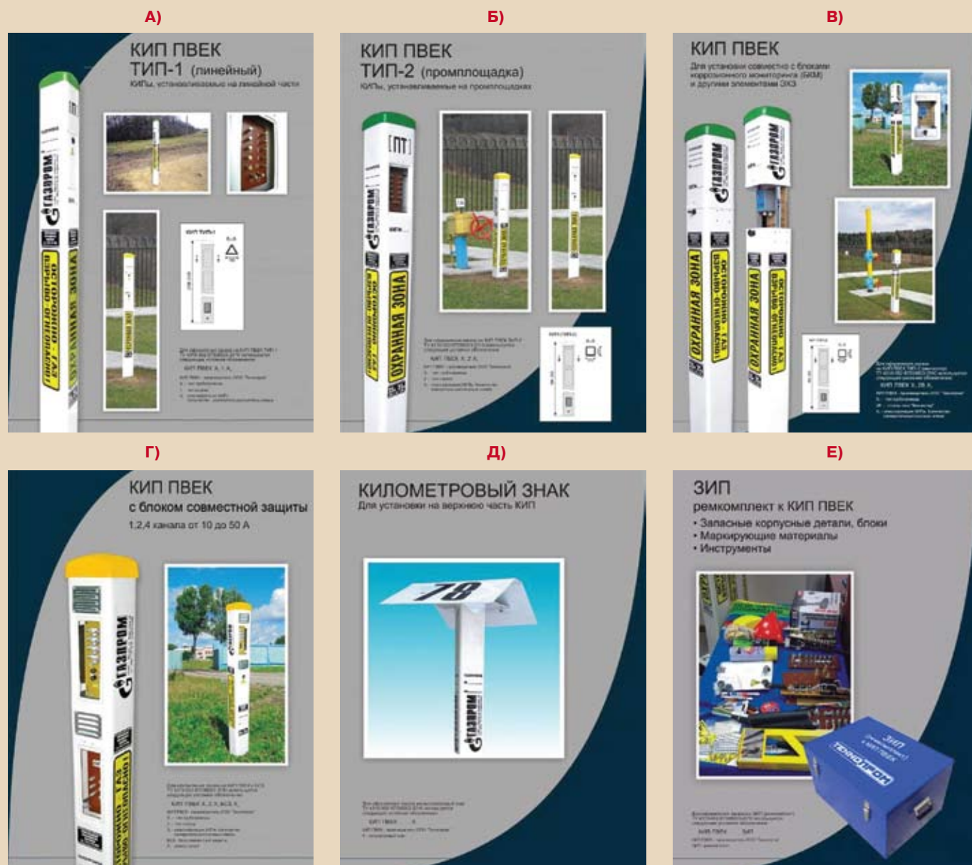
Рис. 7. Примеры КИП ПВЕК, отвечающих требованиям ВТТ 2009 г, для установки на магистральных трубопроводах ОАО «Газпром»: на линейной части (а), на трубопроводах промплощадок КС и ГРС (б); для систем дистанционного коррозионного мониторинга с встроенным блоком преобразования сигналов (в); для совместной защиты с встроенным диодно-резисторным блоком (г); километровый знак (д); комплект ЗИП (е)
