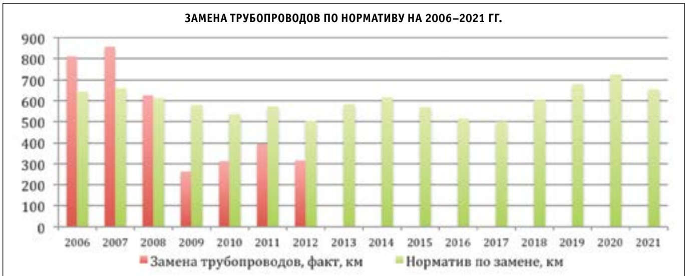
Рис. 8. Замена трубопроводов по нормативу, км. Для 2011–2021 гг. уровень замены по нормативу рассчитан по алгоритму, описанному в [3], на основании сложившегося по состоянию на 2010 г. возрастного профиля трубопроводов. Для 2006–2009 гг. норматив рассчитан по данным о состоянии трубопроводного парка в 2005 г.
