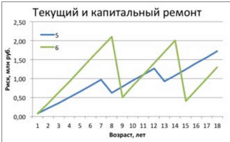
Рис. 3. Зависимость риска «Износ» от срока эксплуатации объекта в зависимости от проведения различных мероприятий по защите и текущему ремонту (линия 5) и только капитальному ремонту без мер по защите (линия 6)
