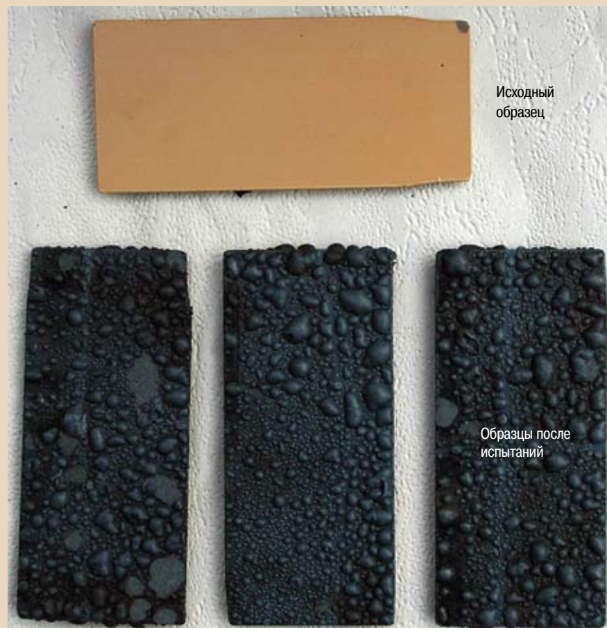
Рис. 5 – Образцы внутреннего покрытия (ТС-2000), не выдержавшие испытания в сероводородсодержащей среде
