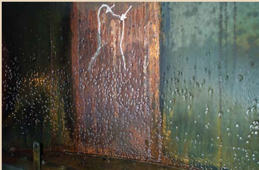
Рис. 1 – Внутренняя поверхность абсорбера с металлическим покрытием после года эксплуатации
