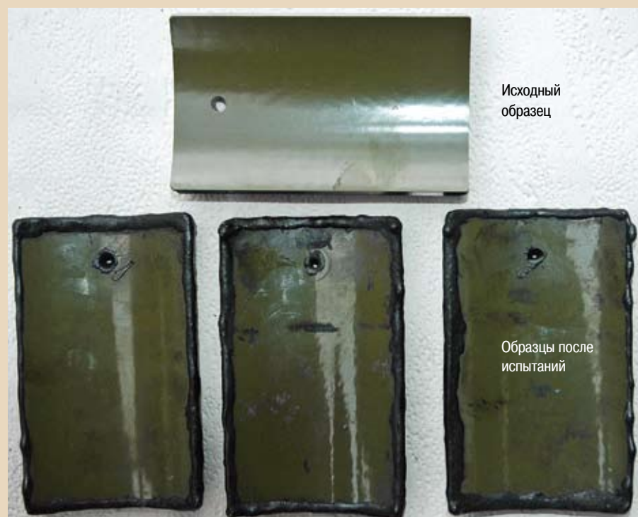
Рис. 4 – Образцы внутреннего покрытия (TK-34P), выдержавшие испытания в сероводородсодержащей среде
