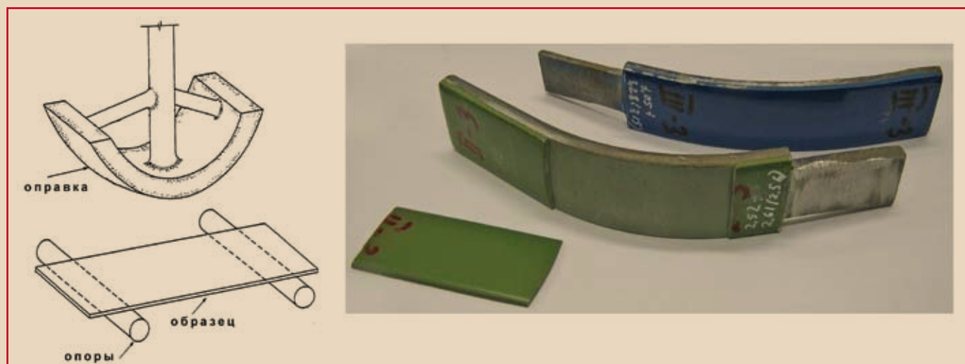
Рис. 2. Определение стойкости покрытия к изгибу
