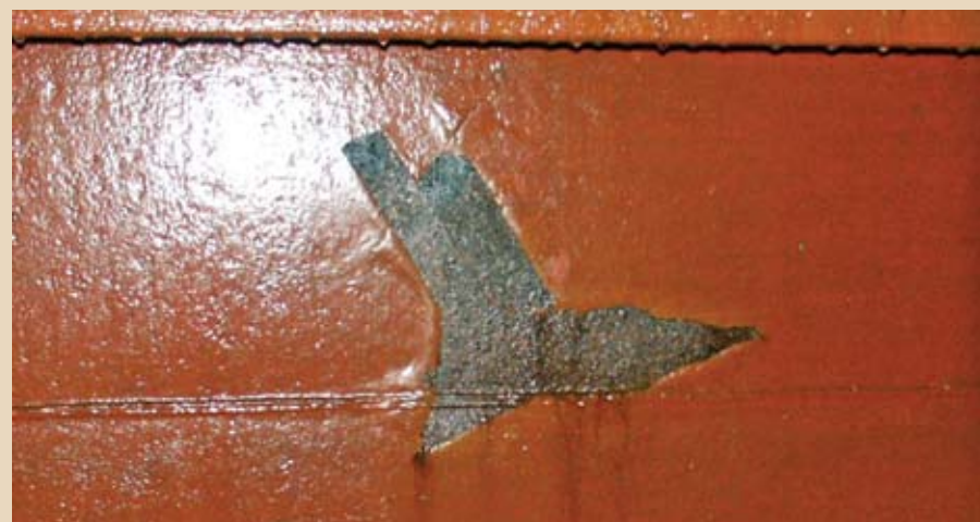
Рис. 2. Внешний вид эпоксидного покрытия 250 мкм (2 слоя), нанесенного по поверхности с содержанием растворимых солей SC-3
