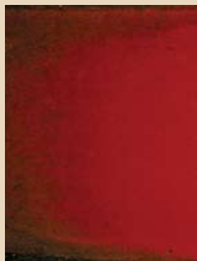
Эпоксидное покрытие толщиной 450 мкм, 2 слоя
