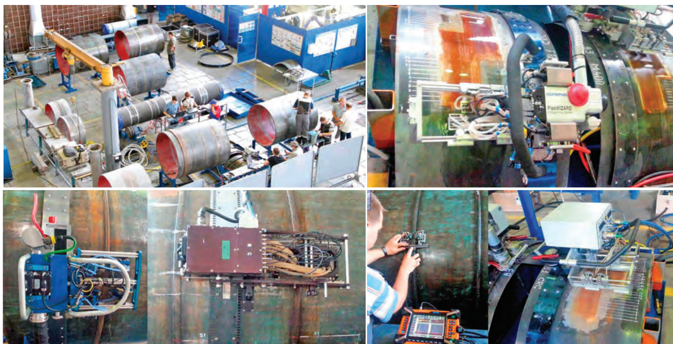
Рис. 6. Проведение квалификационных испытаний средств неразрушающего контроля качества сварных соединений Fig. 6. Conducting the qualification tests of welded joints non-destructive testing means
