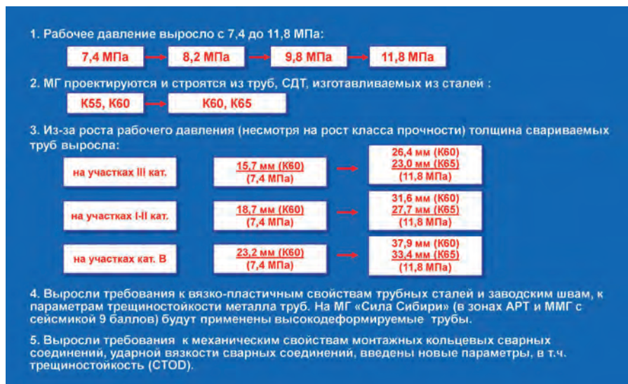
Рис. 3. Изменение технических параметров магистральных газопроводов, требований к трубам, СДТ и сварным соединениям за последние 15 лет
