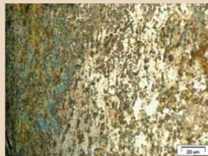
Рис. 4б. Структура стали вблизи поверхности образца после выдержки в асмоле на основе КОРД
