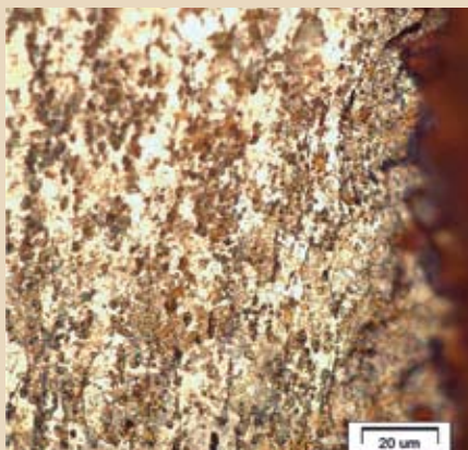
Рис. 4а. Структура стали вблизи поверхности образца после выдержки в асмоле на основе абсорбента А-2
