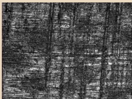
Рис. 3б. Поверхность образца после выдержки в растворе асмола на основе КОРДА
