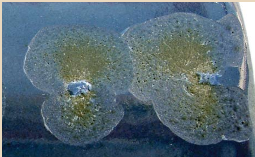
Закрытые поры в силикатно-эмалевом покрытии
