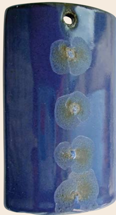
Силикатно-эмалевое покрытие при прямом ударе
