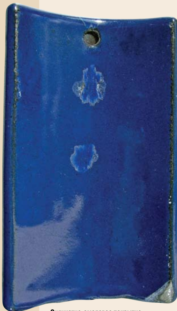
Силикатно-эмалевое покрытие при обратном ударе
