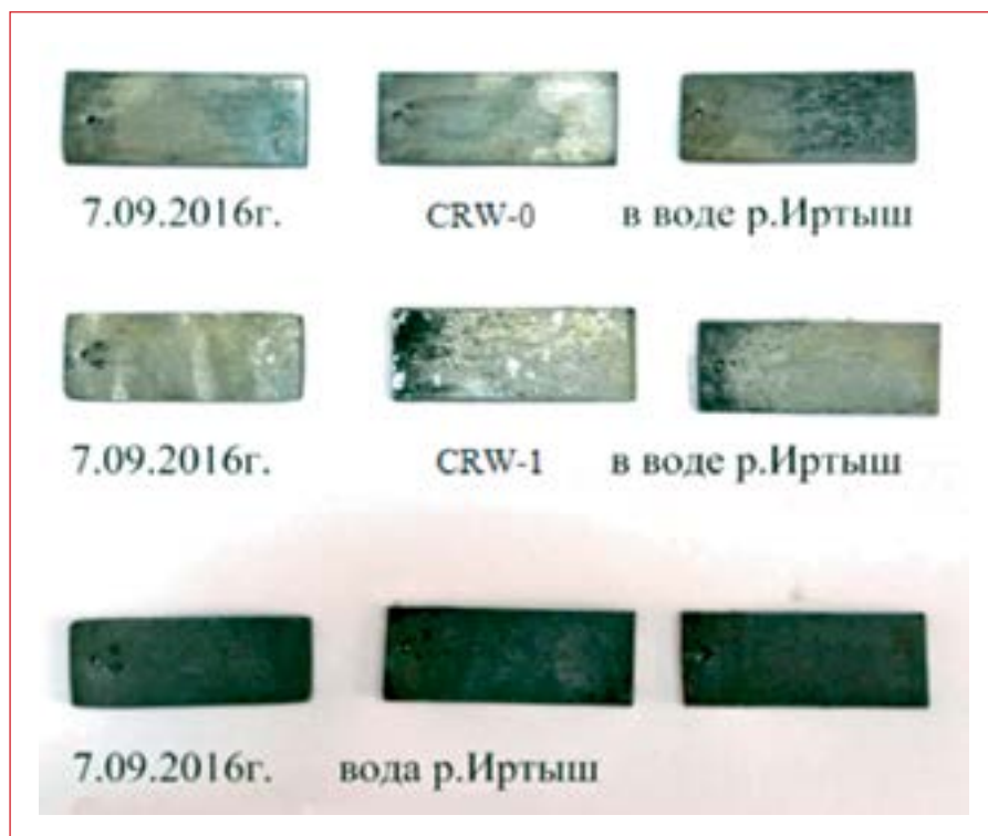
Рис. 2. Вид образцов-свидетелей после коррозионного эксперимента в ингибирующем растворе CRW-0, CRW-1 и в воде р. Иртыш в отсутствие ингибирующего раствора
