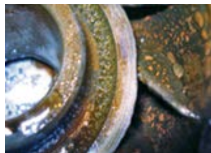
Рис. 7. Осевой износ опор направляющих аппаратов
