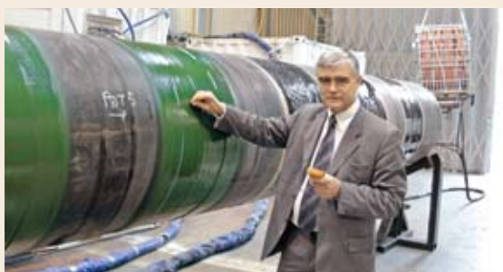
Фото 3. Нанесение в условиях «PIH» на подготовленные участки трубы Ø920 мм двухкомпонентного полиуретанового покрытия «Acothane Spray Grade TX»
