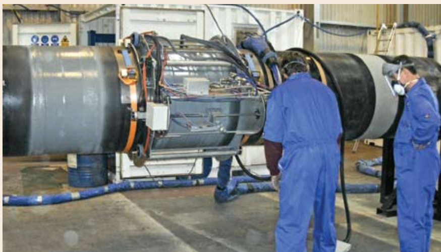
Фото 3. Нанесение в условиях «PIH» на подготовленные участки трубы Ø920 мм двухкомпонентного полиуретанового покрытия «Acothane Spray Grade TX»
