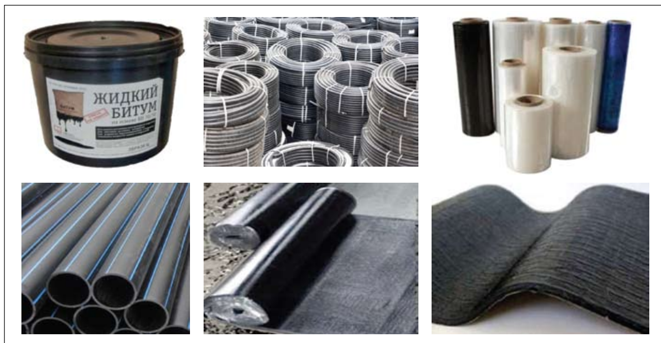
Рис. 5. Продукты переработки изоляционных материалов трубопроводов
