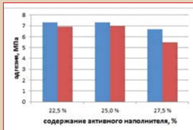
Рис. 4. Адгезия покрытия к стали (n = 6, P = 0,95, синий – образцы в воздушно-сухом состоянии, красный – образцы после насыщения водным электролитом)
