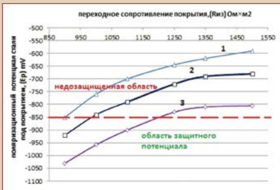
Рис. 2. Зависимость поляризационного потенциала под покрытием от его сопротивления (при установленном потенциале катодной защиты на внешней стенке покрытия (мсэ): 1 – (–900) мВ; 2 – (–1000) мВ; 3 – (–1150) мВ)
