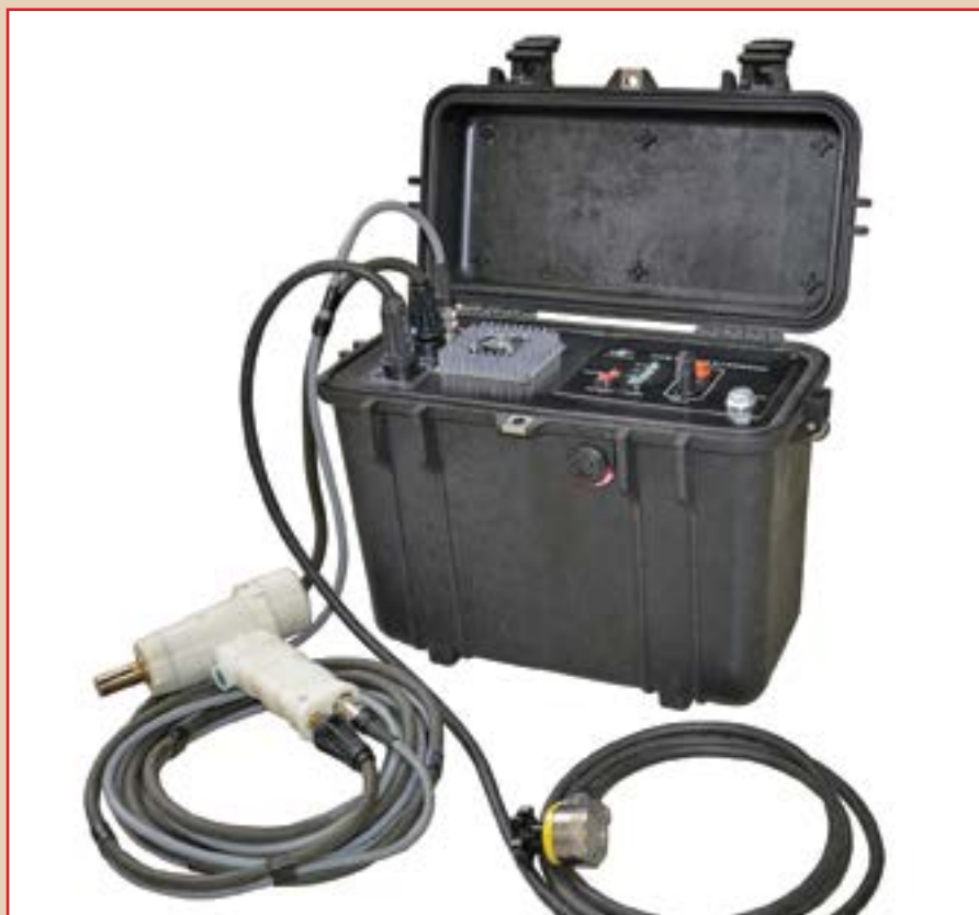
Рис. 1. Установка для припайки катодных выводов ПКВ «Менделеевец»
