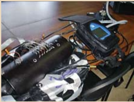
Рис. 3. Внешний вид модели трубы с подключенным оборудованием FSM IT
