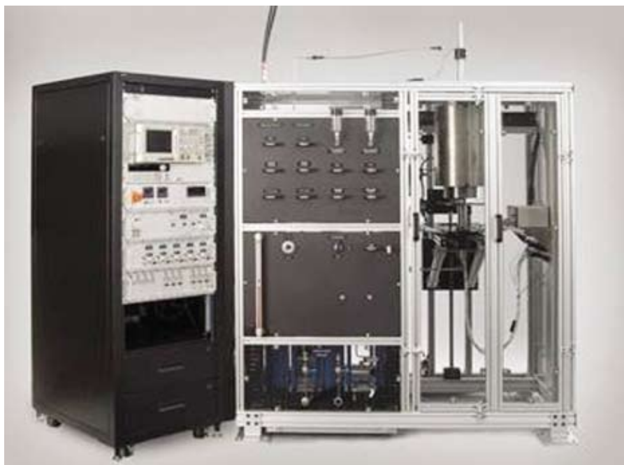
Рис. 1. Установка для измерения звуковых волн AutoLab 1500
