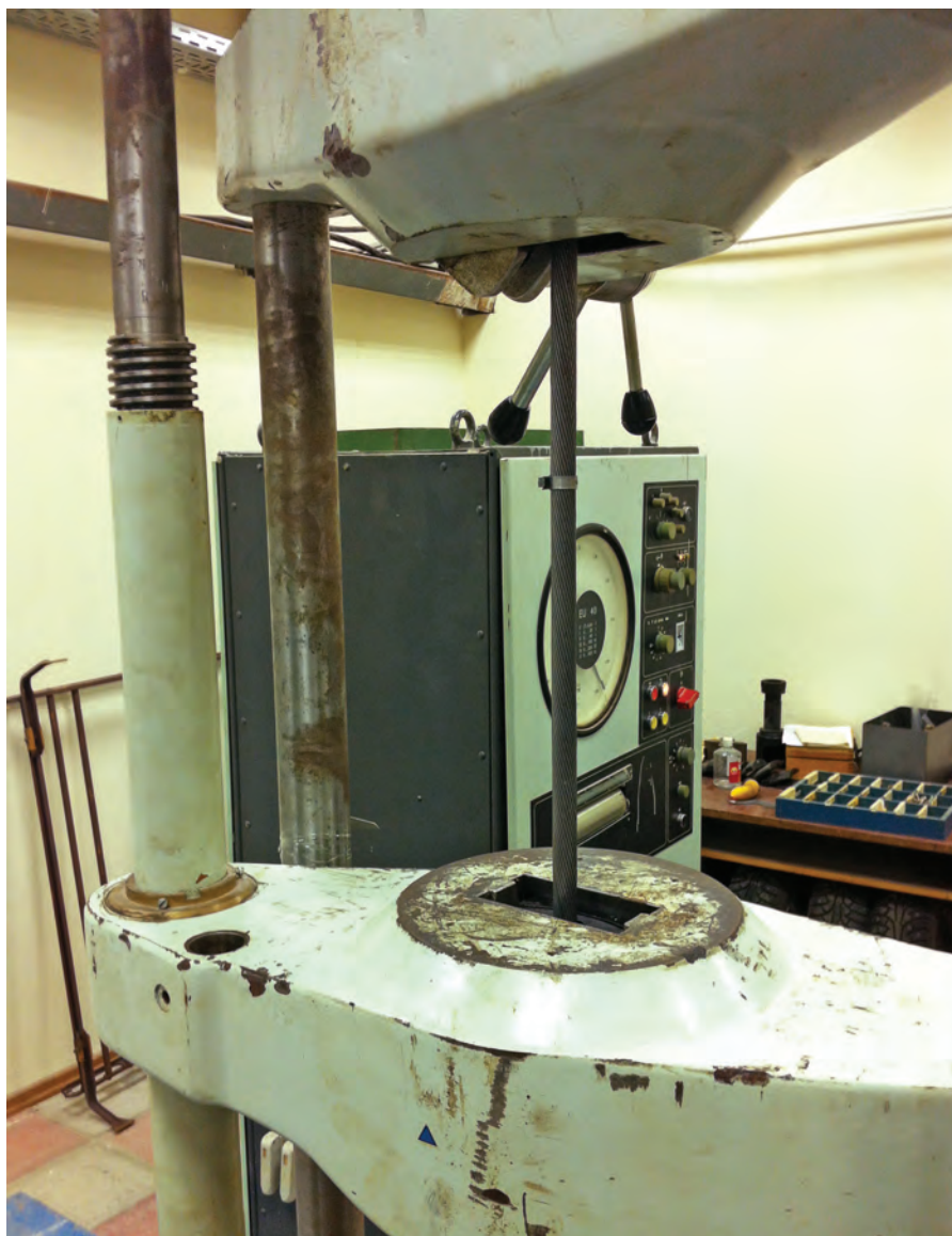
Рис. 5. Испытание образца пластически обжатого каната
