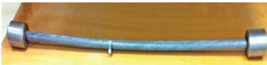
Рис. 4. Образец пластически обжатого каната для испытаний
