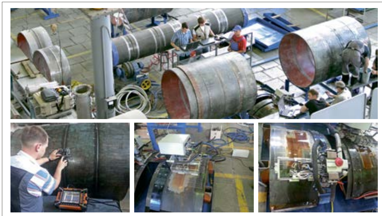
Рис. 2. Квалификационные испытания средств НК качества сварных соединений на площадке Опытно-экспериментального центра ООО «Газпром ВНИИГАЗ»
