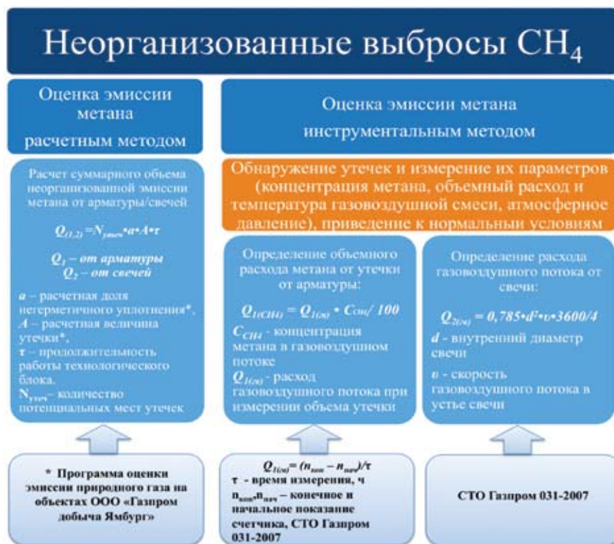
Рис. 3. Алгоритм расчета неорганизованных выбросов метана по ОАО «Газпром»
