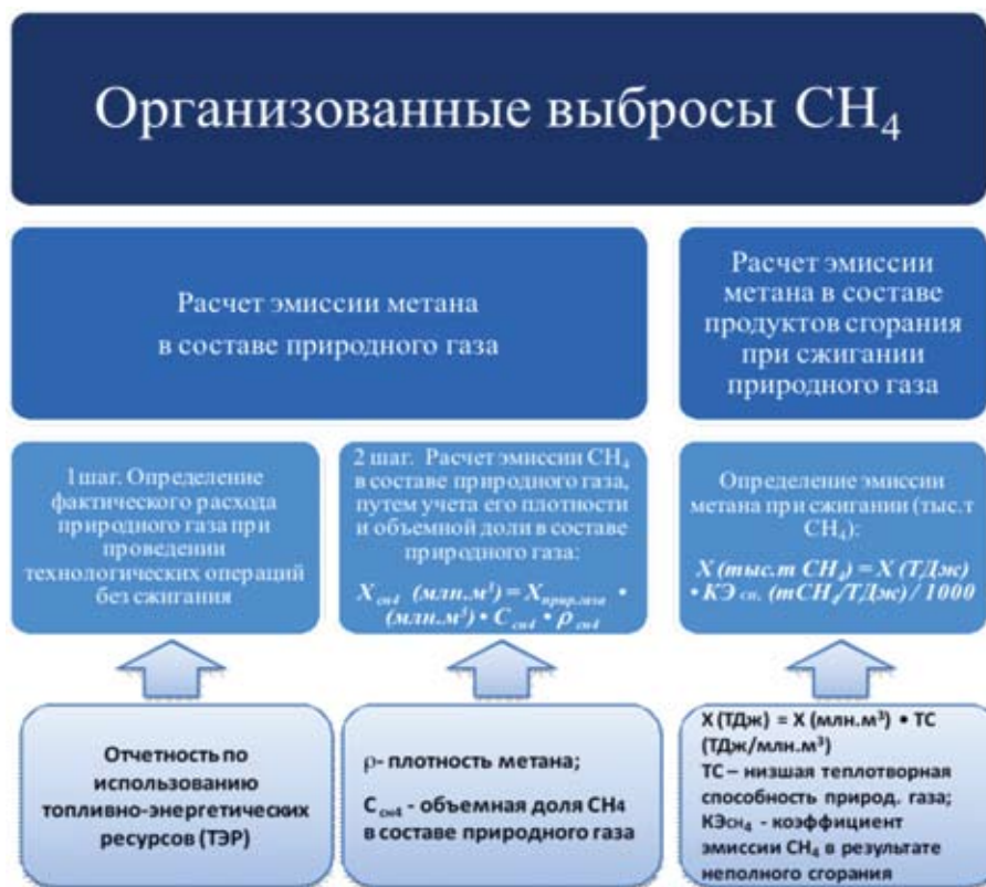
Рис. 2. Алгоритм расчета организованных выбросов метана по ОАО «Газпром»
