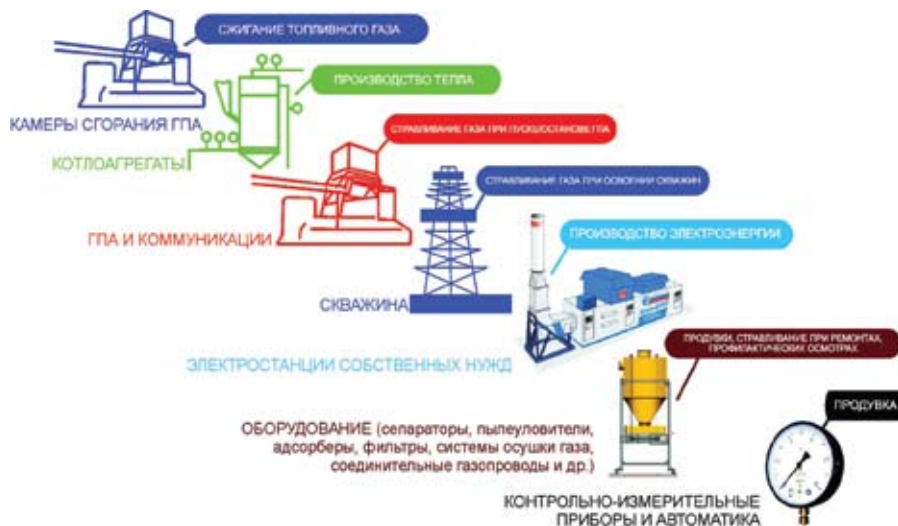
Рис. 1. Технологический процесс, приводящий к выбросу метана в атмосферу
