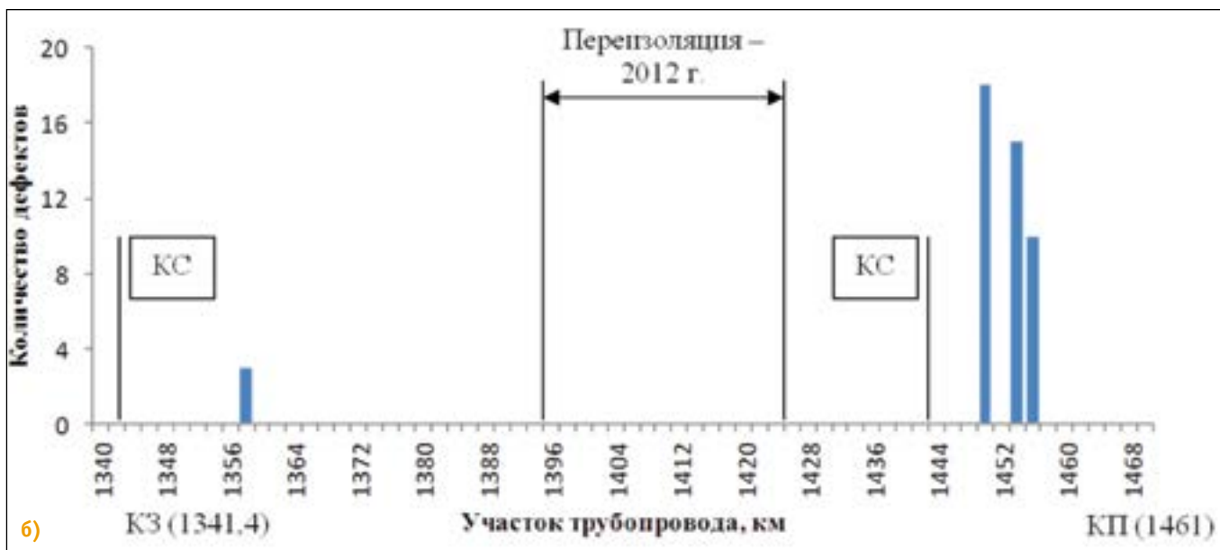
Рис. 1. Распределение стресс-коррозионных дефектов на участке газопровода: а) ВТД 2001 г.; б) ВТД 2007 г.
