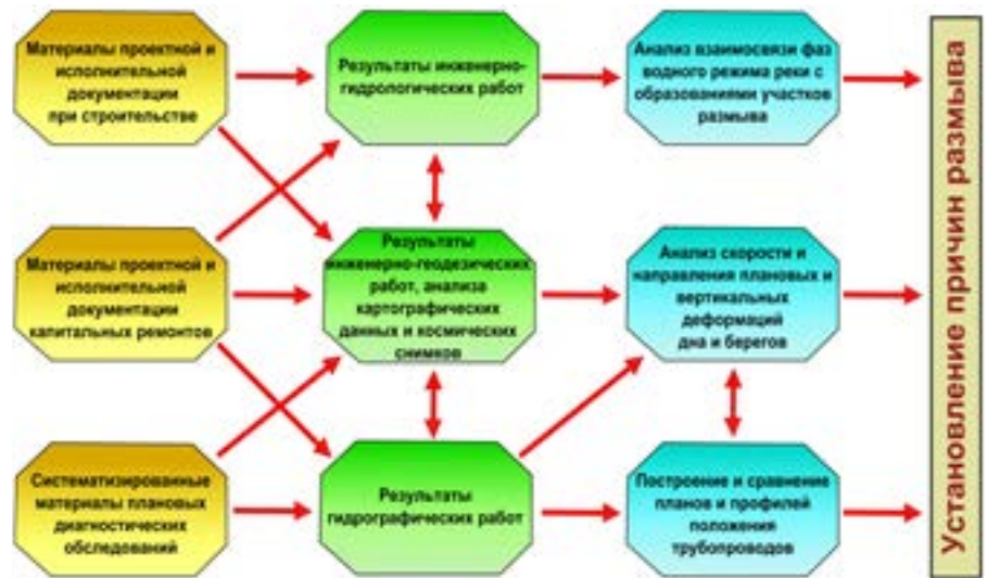
Рис. 2. Схема анализа причин размыва подводных переходов
