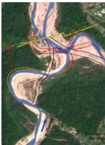
Условные обозначения: — газопровод — шевеленое русло на сентябрь 2012 г. — наиболее благоприятное положение динамической оси потока — опасное положение динамической оси потока — относительно опасное положение динамической оси потока
