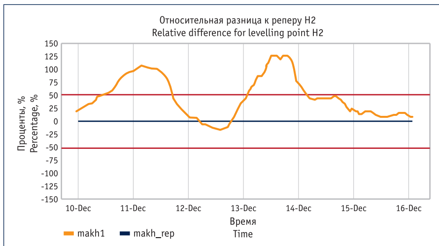
Рис. 10. Аномалии, зафиксированные на оползне г. Тарки-Тай, ПК 607 ГП «Моздок – Казимагомед» Fig. 10. Anomalies recorded in the landslide, Tarki-Tau, PMK 607 SE Mozdok – Kazimagomed
