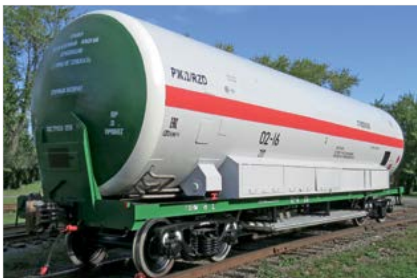
Рис. 1. Железнодорожный вагон-цистерна модель 15-5106 для транспортировки СПГ и этилена
