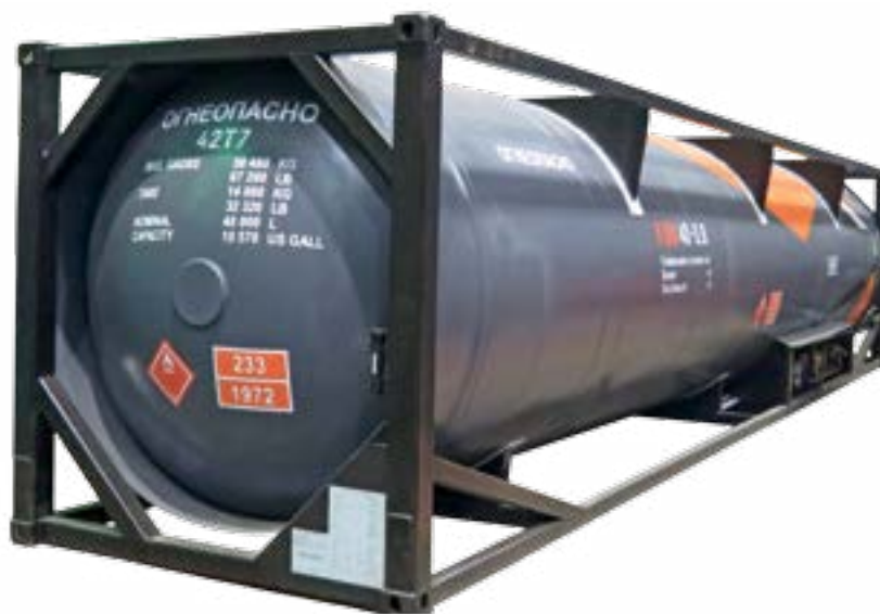
Рис. 2. Контейнер-цистерна модель КЦМ-40/0,7 для транспортировки и хранения СПГ
