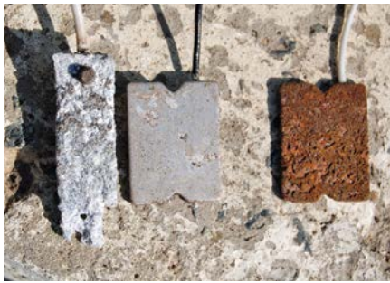
Рис. 1. Технологический магниевый протектор, защищаемая протектором пластина и контрольная пластина после нахождения в грунте в течение шести месяцев (слева направо)
