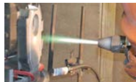
Рис. 3. Технологическая операция по нанесению газотермического высокоскоростного напыления по технологии HVOF
