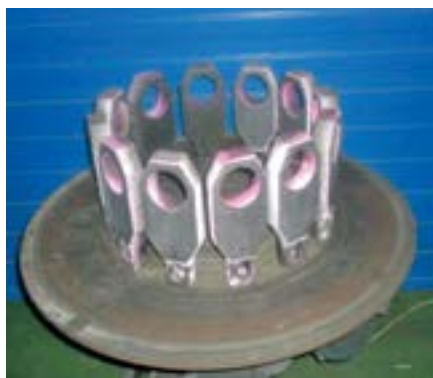
Рис. 4. Цветная дефектоскопия шиберов Fig. 4. Dye penetrant examination of gates
