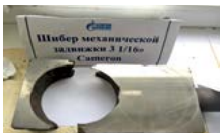
Рис. 1. Пример разрушения шибера задвижки фонтанной арматуры Fig. 1. An example of destruction of the gate of the production treble
