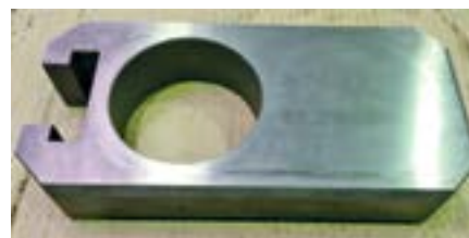
Рис. 6. Отремонтированный шибер ANSON после испытаний на эксплуатационной скважине Fig. 6. Repaired ANSON gate after testing at the production well
