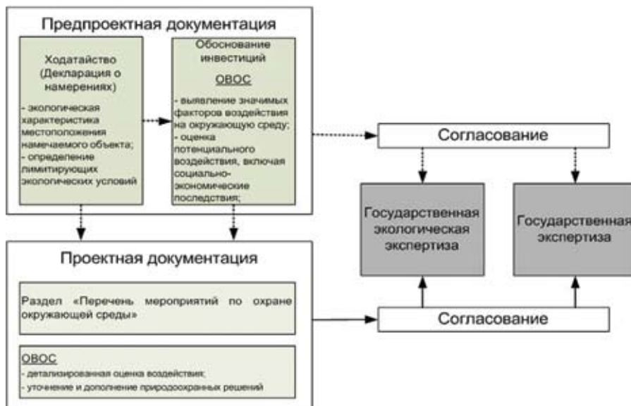
Рис. 1. Схема проведения ОВОС на различных стадиях инвестиционного проектирования
