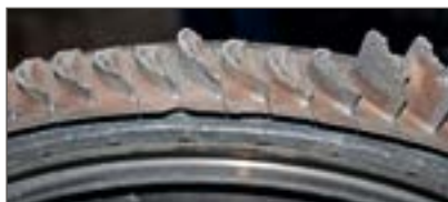
Рис. 1. Обрыв РЛ ТВД Fig. 1. Separation of the rotor blades of high-pressure turbines
