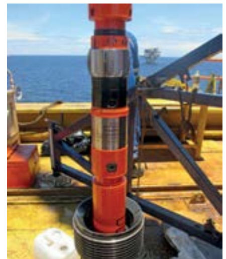
Рис. 6. Монтаж УЭЦН Colibri ESP на грузонесущем кабеле на платформе BODP-C компании Petronas (Малайзия), месторождение Bokok
