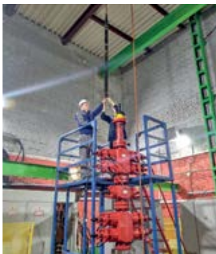
Рис. 7. Стендовые испытания УЭЦН Colibri ESP УКЭЦН81 в стенде-скважине ОКБ БН «КОННАС» (Москва)
