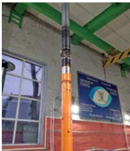
Рис. 7. Стендовые испытания УЭЦН Colibri ESP УКЭЦН81 в стенде-скважине ОКБ БН «КОННАС» (Москва)
