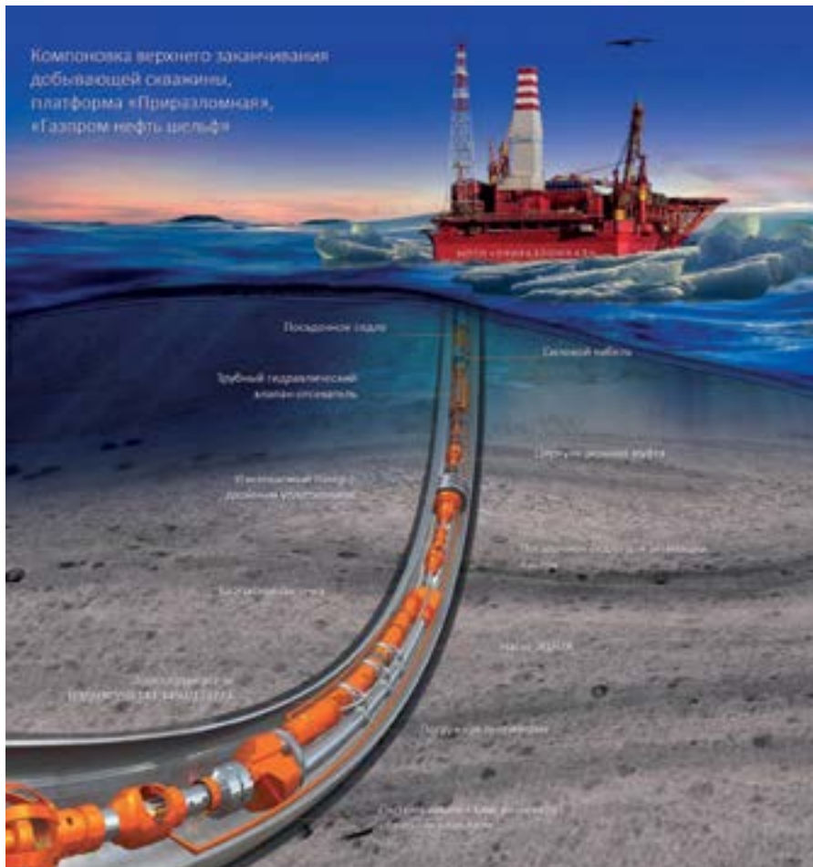
Рис. 1. Система верхнего заканчивания добывающей скважины платформы «Приразломная»
