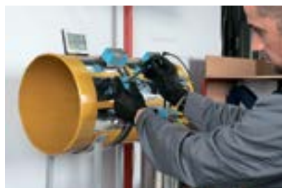
Ультразвуковые датчики на испытательной трубе
