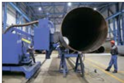
Идет очистка поверхности трубы
