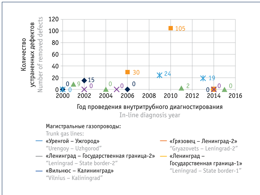
Рис. 3. Количество устраненных дефектов магистральных газопроводов по результатам внутритрубной диагностики в 2000–2016 гг. Fig. 3. The number of removed defects in trunk gas lines based on the in-line diagnosis data, in 2000–2016
