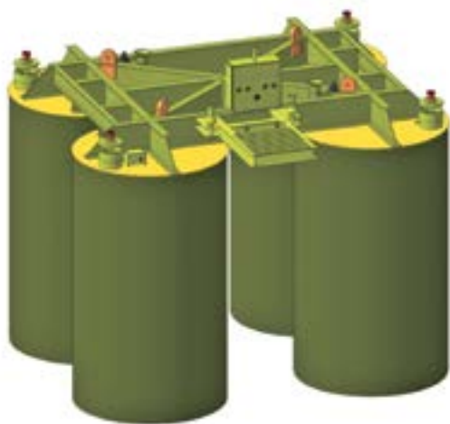
Рис. 5. Общий вид 3D-модели донной опорной плиты манифольда (12,5 × 12,5 × 10 м) Fig. 5. General view of the 3D subsea template manifold model (12.5 × 12.5 × 10 m)
