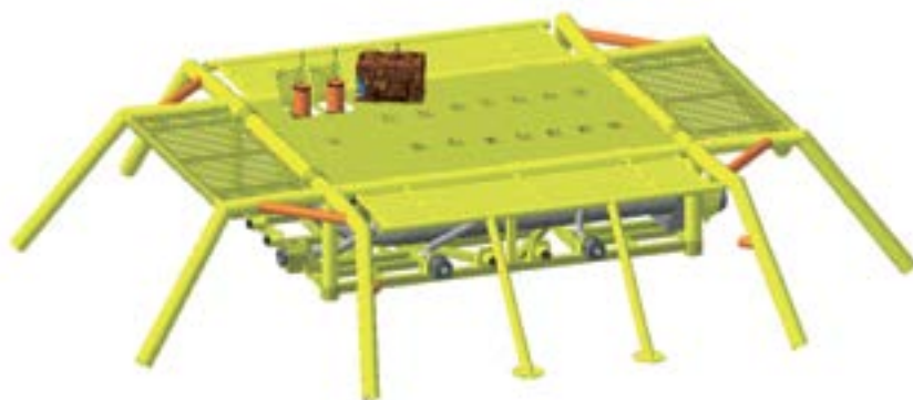
Рис. 2. Общий вид 3D-модели сборного манифольда (38 × 33 × 6 м) Fig. 2. General view of the 3D model gathering manifold (38 × 33 × 6 m)
