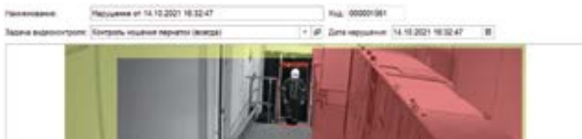
Рис. 2. Определение нарушения в виде цветового выделения и надписи (нет перчаток)
