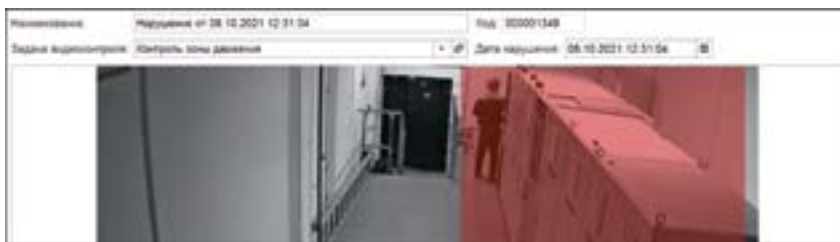
Рис. 3. Определение нарушения пересечения опасной зоны (выделена справа)
