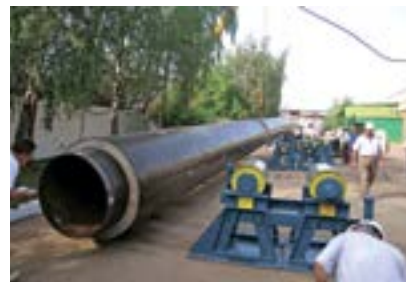
Рис. 6. Испытание на изгиб обетонированной трубной секции Fig. 6. Bending test of a section of concrete weight coated pipe
