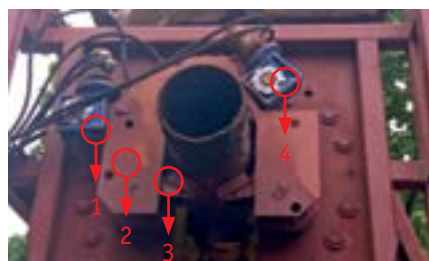
Рис. 2. Захват фиксирующий передний: 1 – гидромотор ходового винта; 2 – корпус модуля переднего захвата; 3 – рычаг прижимной с резиновой накладкой; 4 – гидромотор привода модуля зачистки Fig. 2. Locating grip, front: 1 – hydromonitor of walking screw; 2 – front grip module housing; 3 – pressure-exerting lever w/ rubber block; 4 – hydromonitor of cleaning module drive
