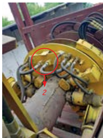
Рис. 4. Шланг подвода диспергента 1 и верхние форсунки 2 на блоке отмыва и зачистки Fig. 4. Dispersent hose 1 and washing and cleaning unit upper jets 2
