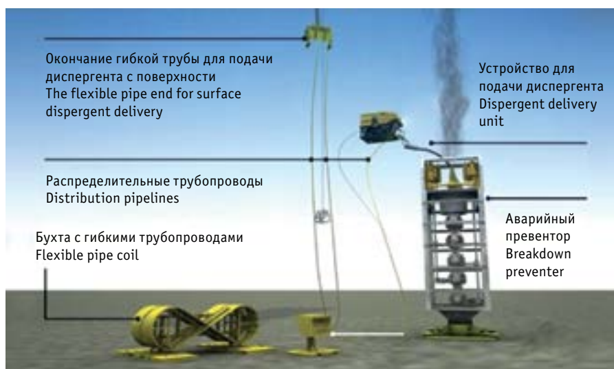
Рис. 1. Оборудование для проведения подводного диспергирования с подачей диспергента с поверхности
