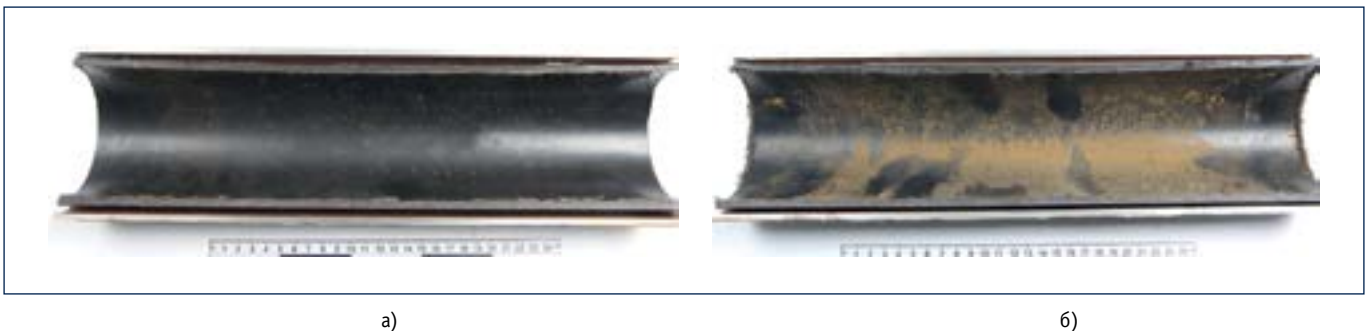
Рис. 4. Внутренняя поверхность полиэтиленовой оболочки трубы после испытаний: а) верхняя образующая; б) нижняя образующая
