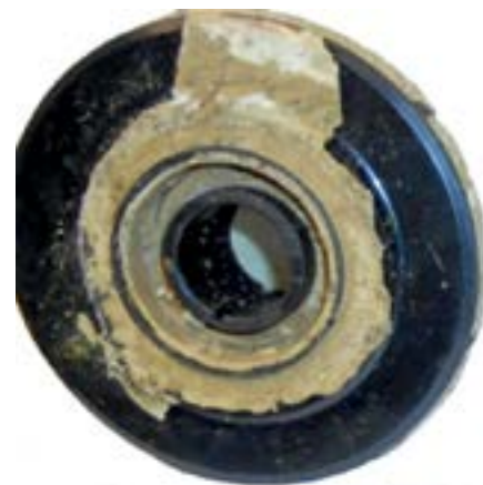
Рис. 6. Солеотложения на рабочем колесе из полимерно-композитного материала Fig. 6. Scales of the polymer-composite impeller
