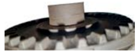
Рис. 5. Абразивно-механический износ ступицы рабочего колеса из полимерно-композитного материала Fig. 5. Abrasive-mechanical wear of the polymer-composite impeller hub
