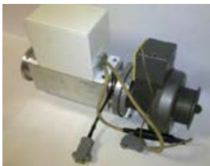
Рис. 4. Экспериментальный образец устройства для определения количества топлива и содержащейся в нем нерастворенной воды в динамических условиях
