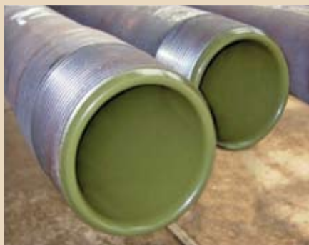
Рис. 2. НКТ с внутренним покрытием ТК 236
