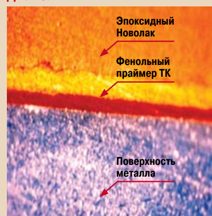
Рис. 1. Защитное покрытие ТК в разрезе под увеличением
