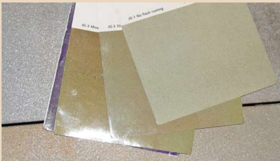
Сравнение обработанных пластин с эталонными образцами Jotun спустя 3 часа после обработки
