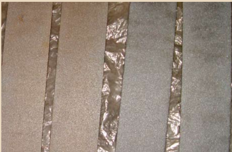
Четыре стальные пластины одновременно обработаны гидropескоструйным способом. Пара слева – контрольная – без ингибитора, пара справа – с 2%-ным раствором ингибитора «АМИДАЛ». Спустя 10 минут после обработки
