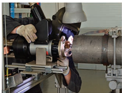
Рис. 5. Установка сварки элементов ТЛТ
