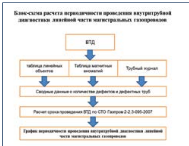
Рис. 2. Блок-схема расчета периодичности проведения внутритрубной диагностики линейной части магистральных газопроводов
