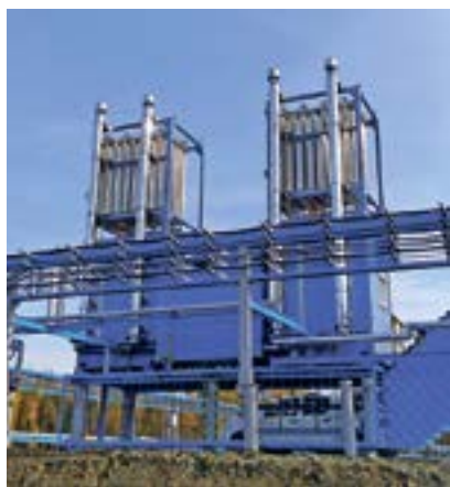
АВТОНОМНЫЙ ИСТОЧНИК ПИТАНИЯ НА БАЗЕ СВОБОДНОПОРШНЕВЫХ ДВИГАТЕЛЕЙ СТИРЛИНГА ДЛЯ МОДУЛЯ АВТОМАТИЗИРОВАННОЙ ТЕХНОЛОГИЧЕСКОЙ ОБВЯЗКИ СКВАЖИН (СЛЕВА) И АВТОНОМНЫЙ КОМПЛЕКС ЭЛЕКТРОСНАБЖЕНИЯ АКЗ-100/500-001 ДЛЯ ОБОРУДОВАНИЯ МАЛОЙ МОЩНОСТИ (СПРАВА)
